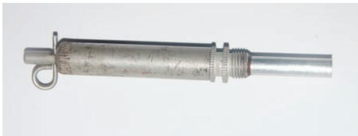
Fot. 112. Zapalnik o działaniu odciągowym do miny POMZ-2M składający się z:
