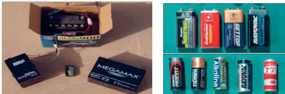
Fot. 81. Przykłady stosowanych źródeł zasilania: a – akumulatory; b – baterie.
