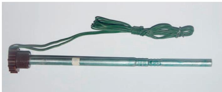
Fot. 97. Zapalnik elektryczny do miny MKU.
