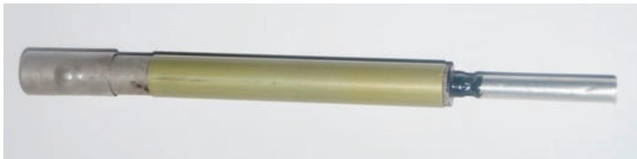
Fot. 90. Zapalnik mechaniczny o działaniu naciskowym.
