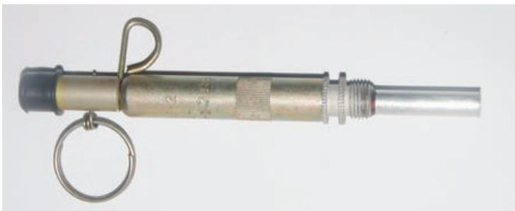
Fot. 113. Zapalnik o działaniu odciągowym do miny POMZ-2M składający się z:
