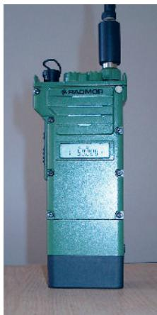
szczebla drużyny i plutonu. Dzięki małym wymiarom i niskiej masie może stanowić osobiste wyposażenie żołnierzy. Radiostacja przeznaczona jest do pracy w ruchu (marszu), w warunkach stacjonarnych (okop, budynek, schron) w dowolnych warunkach pogodowych i klimatycznych.
