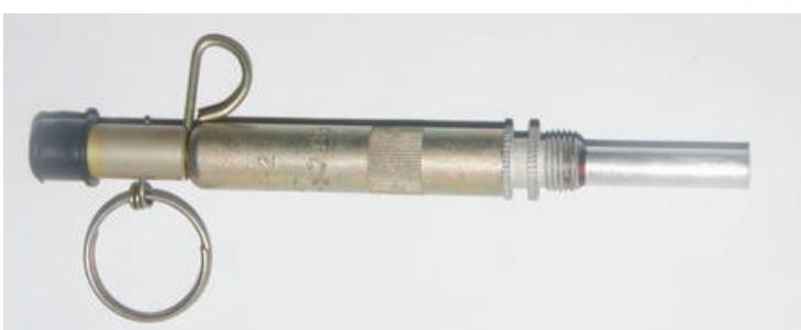
Fot. 126. Zapalnik o działaniu odciągowym do miny MON-100 składający się z: mechanizmu uderzeniowego MUW-2 oraz zapalu MD-5M.
