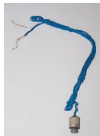
Fot. 117. Zapalnik elektr. miny PSM-1.
